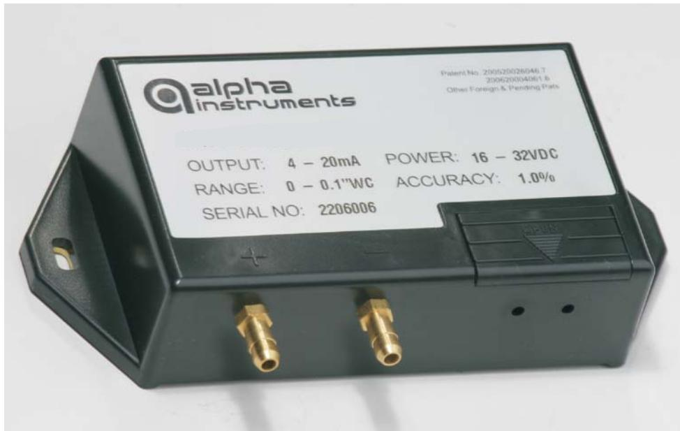
Model 166H系列微差压传感器的核心部件是一个电容式压力敏感元件，由不锈钢膜片与固定电极构成一个电容，其值随压力变化而变。采用本公司特殊专利技术精心设计的传感器敏感元件和独特的检测电路确保了产品良好的温度性能和长期稳定性。
